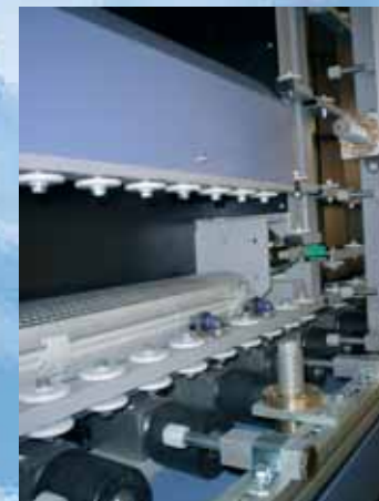
BARRA DI RIFERIMENTO CON PIEDINI POSIZIONAMENTO CANALINO / REFERENCE BAR WITH BEARINGS FOR SPACER FRAME POSITIONING
