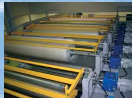
⑤ Tavolo di rifilatura pneumatico per vetri piccoli/ Trimming system for small glass with pneumatic table/ Mesa de recorte neumática para vidrios pequeños/ Table d'ébarbage pneumatique pour verres petits/ Pneumatischer Beschnitt-Tisch für kleine Glasscheiben/ Mesa pneumática para corte das extremidades para vidros pequenos
